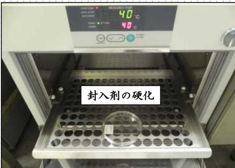
②封入剤を硬化させるためスライドガラスを水平に保った伸展器の上に置き、37~50℃にて封入剤の硬化を待つ。
